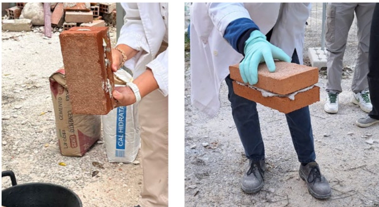
Figura 8. Izquierda, ladrillo recibido en vertical; derecha, ladrillo sustentado en horizontal
