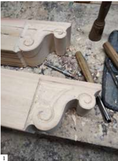
1: Support corbels for the eaves made by Miguel Ángel Balmaseda 2: Restoration of the brickwork in the spandrel 3: Process of cobbling and paving the open carriage porch | 1: Ménsulas de apoyo del tejeroz realizadas por Miguel Ángel Balmaseda 2: Restauración del ladrillo de la enjuta 3: Proceso de empedrado y enchinado del apeadero descubierto | 1: Mísulas de soporte do beiral executadas por Miguel Ángel Balmaseda 2: Restauro do tijolo na enjuta 3: Processo de empedramento e calçada da cocheira descuberta (1: Miguel Ángel Balmaseda 2: Sebastián Pérez Gómez 3: Urbipac)
